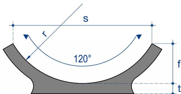
Die DURA.PC-Sohlschale mit Fuß wird als korrosions- und abriebfeste Auskleidung der Trockenwetterrinne bei unterschiedlichen Kanalquerschnitten verwendet. Die Standardlänge der Sohlschalen von 1,0 m reduziert den Fugenanteil der Auskleidung drastisch.
