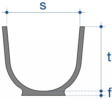
Bei der Sanierung von Gerinnen aus Ortbeton oder Klinker sorgt die DURA.PC-Schachtrinne für ein korrosionsbeständiges und abriebfestes Gerinne.
