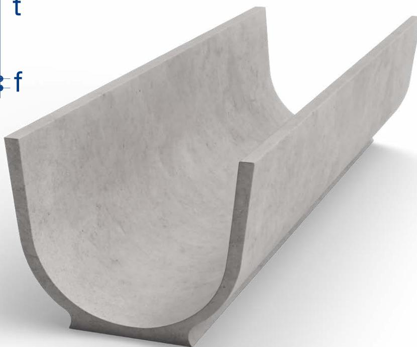
Die Schachtrinne wird in das beschädigte Bodenprofil eingebaut. Der schwalbenschwanzförmige Fuß im Sohlenbereich gewährleistet die sichere Verankerung im Schachtboden.
