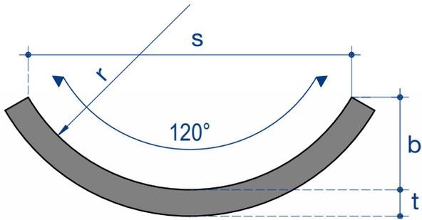
Die DURA.PC-Sohlschale ohne Fuß findet bei Kanalumbauten und -reparaturen Verwendung. Durch die sandgestrahlte Rückseite der Bauteile wird eine optimale Verbindung im Mörtelbett erzielt. Drittel-Sohlschalen kommen meist in Verbindung mit den DURA.PC-Wandplatten zum Einsatz.
