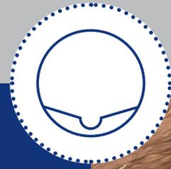
Weist ein Kanal lediglich Schäden im Sohlen- oder Scheitelbereich auf, ist eine Vollsanierung wirtschaftlich nicht immer sinnvoll. Bei begehbaren Kanälen kommt daher häufig die Rohrsegment-Auskleidung als Sanierungsmethode zum Einsatz.
